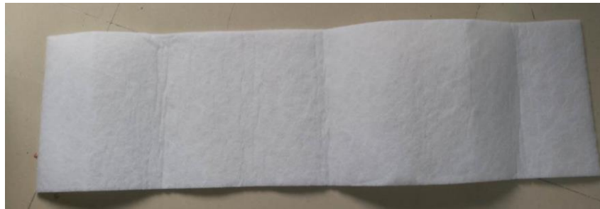
图 1 空调混合风过滤网
