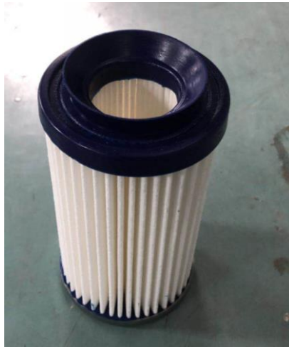
图 1 空压机空气过滤网
